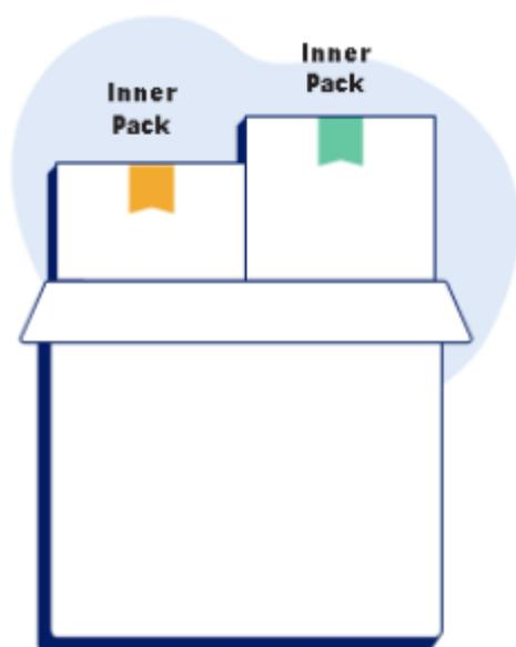
Si contenu < 23 kg (50 lb), utiliser une ondulation à double paroi. Si contenu < 31 kg (68 lb), utiliser une ondulation à triple paroi. Doit peser au moins 90 kg (200 lb) au test de résistance à l'éclatement\* et 32 au test d'écrasement des bords\*.
