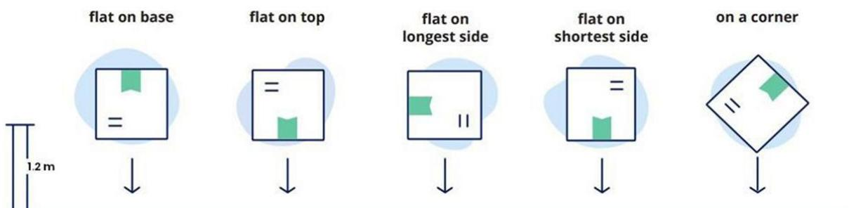
Si votre emballage peut protéger votre produit lors de ces tests, il a passé le 4 - test de chute de pied. Les produits doivent également résister à un test d'agitation vigoureuse d'une minute complète sans qu'aucun contenu ne se brise.
