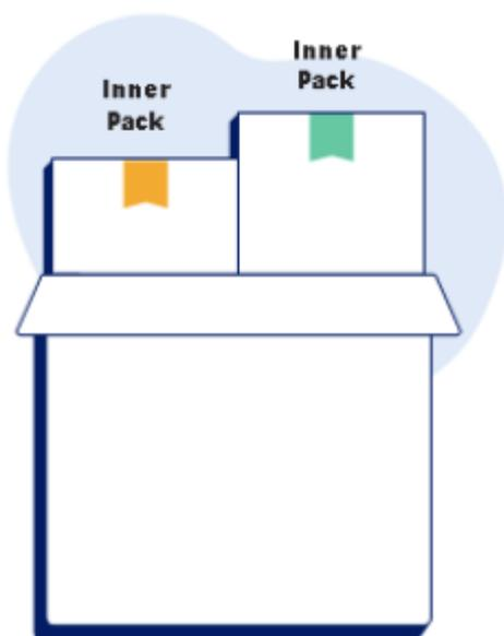
Si contenu < 23 kg (50 lb), utiliser une ondulation à double paroi. Si contenu < 31 kg (68 lb), utiliser une ondulation à triple paroi. Doit peser au moins 90 kg (200 lb) au test de résistance à l'éclatement\* et 32 au test d'écrasement des bords\*.
